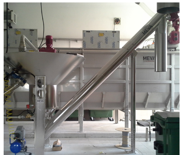
MCU yhdistettynä hiekkapumpulla Meva SWA -hiekkapesuriin
