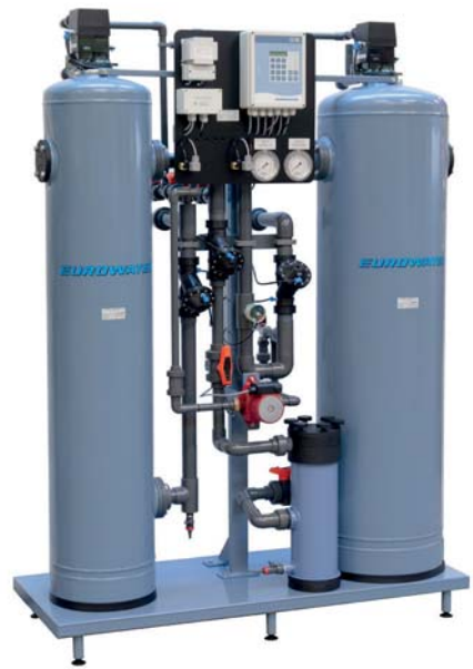
DMHE Täysautomaattinen suolanpoistolaite myötävirtaelvytyksellä. Virtaama: Jopa 20 m 3 /h Johtokyky: 5-20 µS/cm Laatu: 5-20 µS/cm
