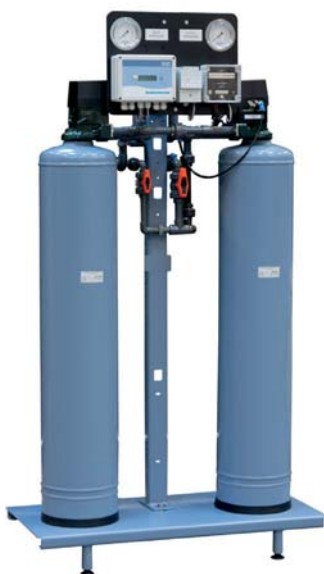
DMS Puoliautomaattinen suolanpoistolaite myötävirtaelvytyksellä. Virtaama: Jopa 5 m 3 /h Johtokyky: 5-20 µS/cm Laatu: 5-20 µS/cm
