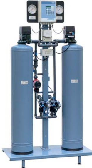
DME Automattinen suolanpoistolaite myötävirtaelvytyksellä. Virtaama: Jopa 5 m 3 /h Johtokyky: 5-20 µS/cm Laatu: 5-20 µS/cm
